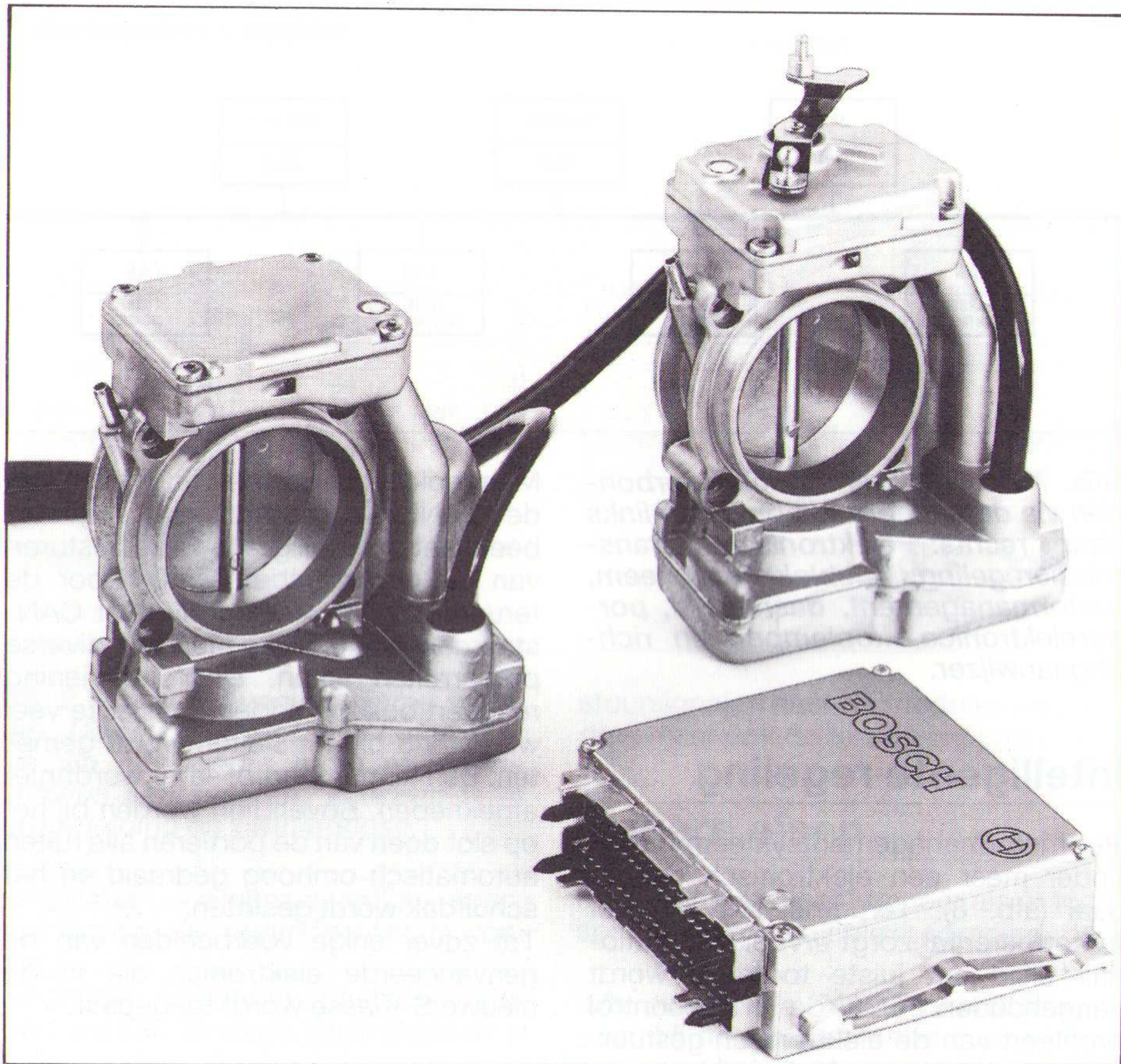
Afb. 8 Bij de 12-cilinder V-motor, die is opgebouwd uit twee 6-cilinderblokken, wordt voor elke cilinderrij onafhankelijke motorelektronica toegepast. Twee smoorkleppen met elektronische gestuurde stappenmotoren maken deel uit van het motor-managementsysteem.
